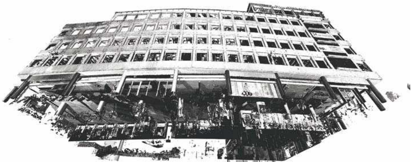
Als Ergebnis erhält man so genannte Punktwolken, die für die CAD-Planung oder Visualisierung genutzt werden können (Laser Scanning Architecture)
